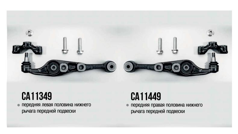
Оригинальные рычаги для Mazda 6, а также их заменители-аналоги, традиционно продаются в виде двухсоставного комплекта в сборе со всеми сайлентблоками и шаровой опорой, входящей в состав рычага.
